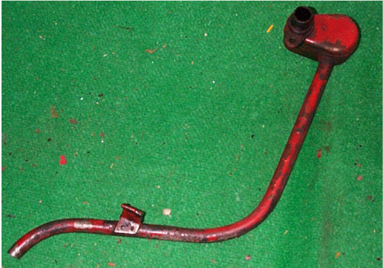
Oljefälla och rör för öppen vevhusventilation, på P1800 fram till chassinummer 8453, (d.v.s. tillverkningsserie VD/HD, årsmodell 63/64.). Rörets öppning mynnar nere strax framför svänghjulskåpan. Röret finns i två utföranden, en "tidig variant", nr 418615-1, och en senare variant, 419848-1.
