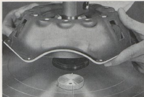
Bild 16. Placering av koppling i fixtur, I 1. Distansklots nr 0
