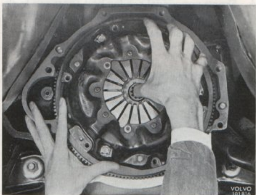
Bild 12. Demontering av koppling
