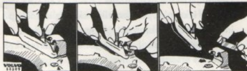
Bild 18. Demontering av hävarmar
