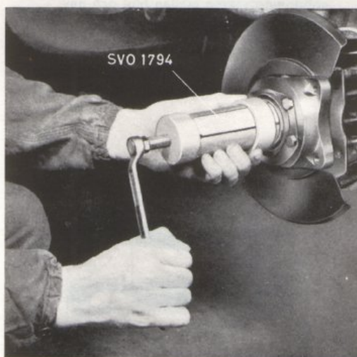
Bild 26. Demontering av inre lager.
