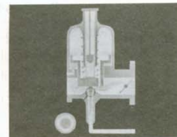
Bild 13. Förgasare vid normal drift
