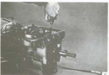
Bild 61. Ett enkelt sätt att kontrollera om kopplingar, bromsband och regulator fungerar är att prova dom med tryckluft. Dessa kontroller finns beskrivna i verkstadshandboken. Vi visar här proven med demonterad växellåda, men de kan också göras med växellådan i vagn. På bilden här provas främre kopplingen och regulatorn. Om kopplingen fungerar skall ett dunk höras när tryckluft släpps på. Regulatorn skall vara vänd så att regulatorvikten vid pilen pekar nedåt. När tryckluft släpps på skall vikten lyftas. Hur denna typ av regulator som du ser här på bilden monteras finns beskrivet i ett verkstadsmeddelande.
