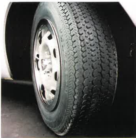
Neue 5 1/2" Felgen mit viereckigen Kühlkanälen und verchromten Radmuttern. Breite „High-speed“-Gürtelreifen 185/70 HR 15.
