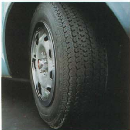
Nya 5 1/2" fälgar med fyrkantiga kylhål och förkromade hjulmuttrar. Breda radialdäck av högfartstyp 185/70 HR 15.
