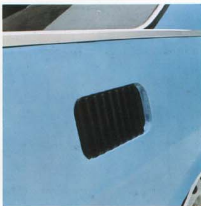
Genomluftningssystemet ger behaglig luftväxling i kupén. Utan drag. Backventilen hindrar avgaser att tränga in bakvägen.
