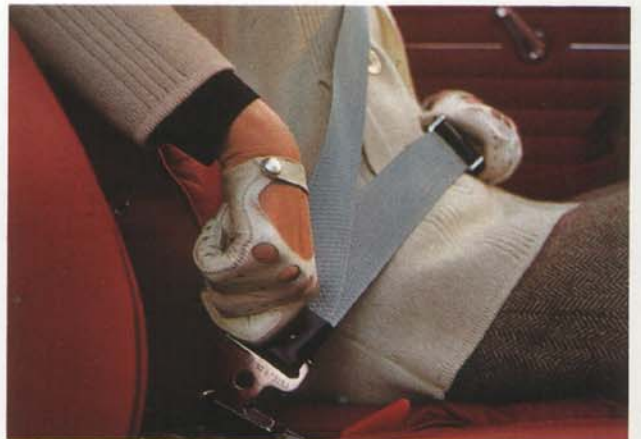
Säkerhetsbältena är av trepunkts-typ och har kraftiga förankringspunkter i karossen.
