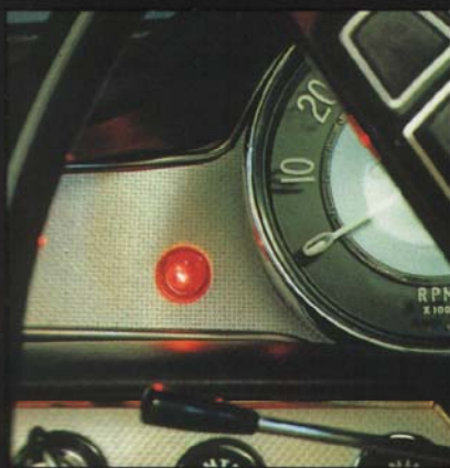
En varningslampa på instrumentbrädan lyser för inödragen parkeringsbroms eller ev. bromskrets-fel.
