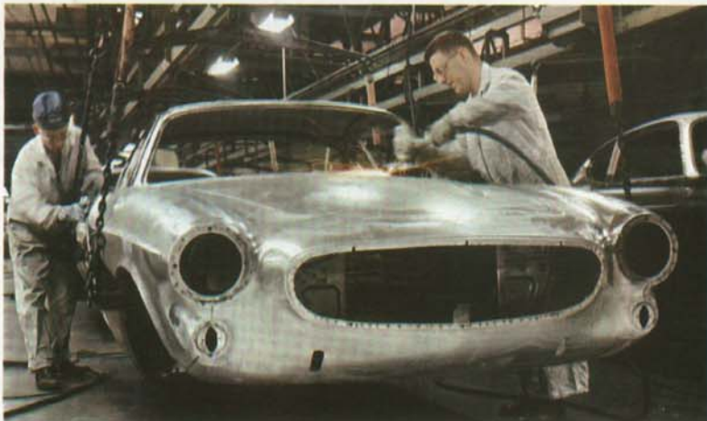
Självbärande kaross – vridstyv enhet för enastående vägegenskaper och god säkerhet.
