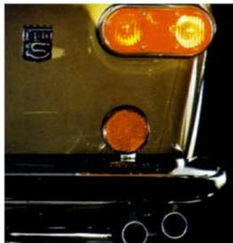
Warn-Blinkanlage über vordere und hintere Blinkleuchten serienmässig.
