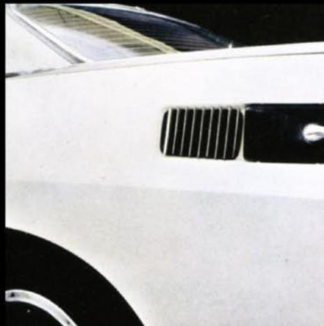
Die Heckscheibe wird elektrisch beheizt. Die Luftschlitze im Fahrzeugheck garantieren zugfreie Zwangsentlüftung.
