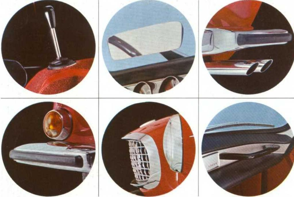
KNÜPPELSCHALTUNG / BLENDFREIER RUCKBLICKSPIEGEL / AUSPUFFROHR MIT DOPPELTEN SCHLUSSROHREN / STOSSFÄNGER MIT GUMMISCHUTZ % ELEGANTER KÜHLERGRILL AUS LEICHTMETALL / HALTEGRIFF FÜR BEIFAHREER
