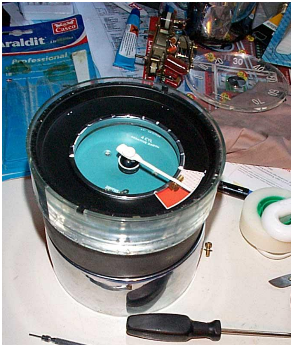
Ljusblå "bakgrundsskivan" fäst ovanpå nya verket, samt lite återanvändning av visarfäste från VDO-räknaren, där jag helt sonika fäste den vita Smiths-visaren ovanpå, under inpassning och limning.
