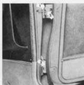
Fig. 25. Door hinges. 1 and 3. Hinges (light oil) 2. Door stop (paraffin wax)
