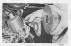
Fig. 28. Replacing air cleaner.
