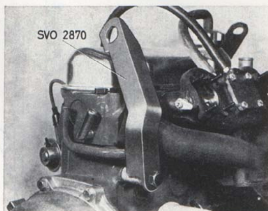
Bild 12. Montering av lyftöra 2870
