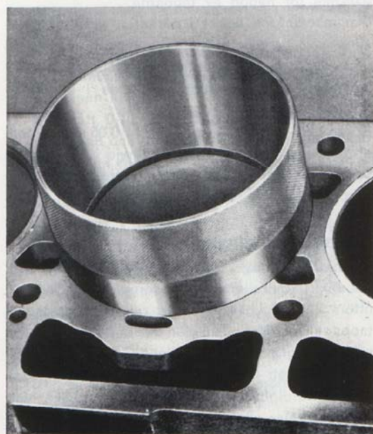
Bild 44. Montering av kolv med monteringsring 2823
