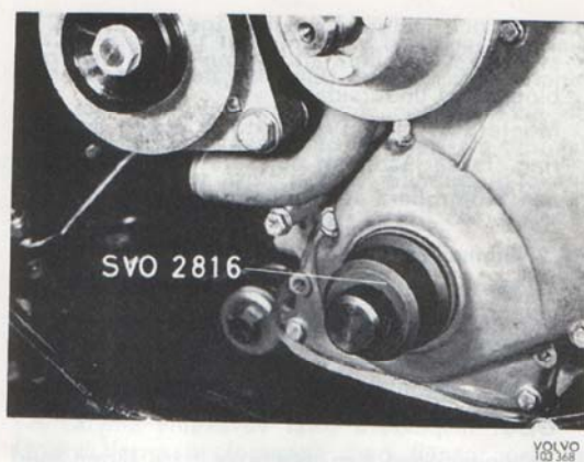
Bild 50. Montering av tätningsring
