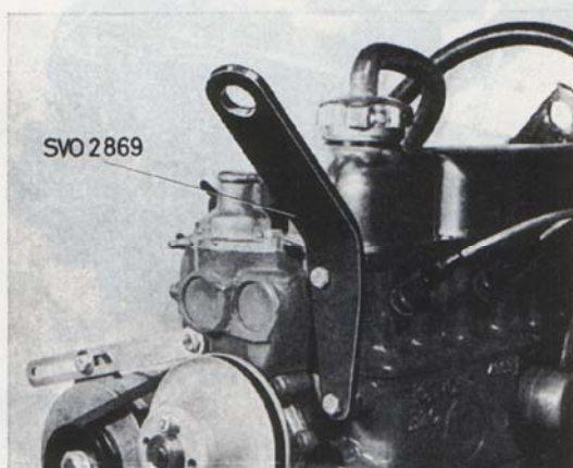
Bild 11. Montering av lyftöra 2869
