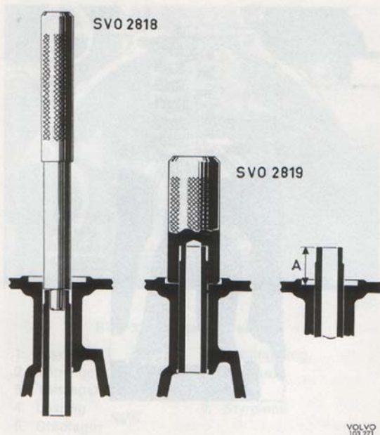
Bild 34. Byte av ventilstyrningar
