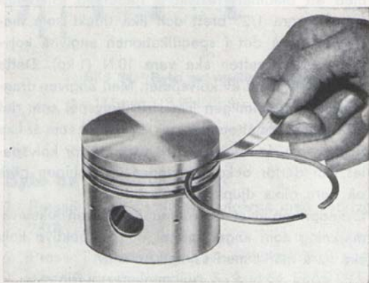
Bild 39. Mätning av kolringsspel i spår
