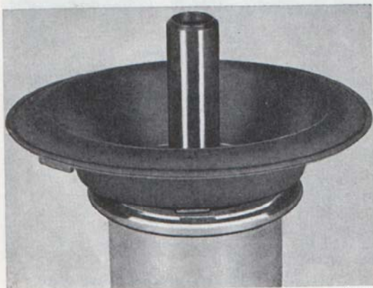
Bild 91. Membran och vakuumkolv
