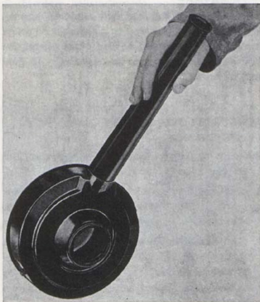
Bild 96. Luftrenare med ej utbytbar insats, Typ III
