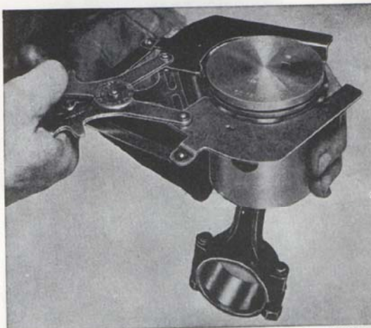
Bild 39. Montering av kolvringar
