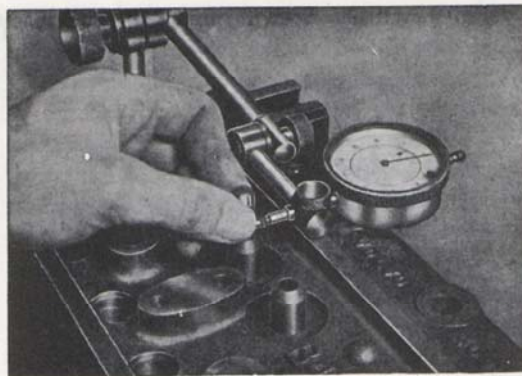
Bild 21. Mätning av spel ventil-styrning
