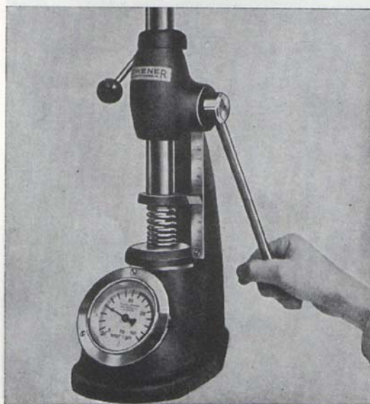
Bild 25. Provning av fjäder
