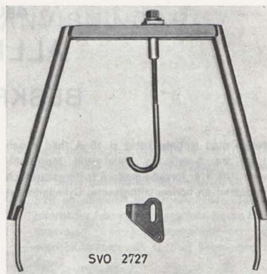
Bild 3. Lyftbygel används vid demontering av oljesump. 140-serien
