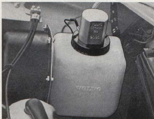
Bild 103. Vindrutespolare, sen. utf., monterad
