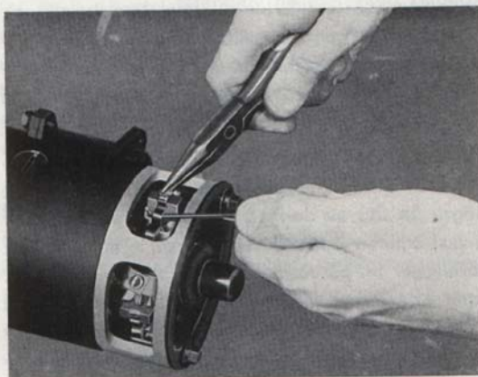
Bild 42. Demontering av elborstar
