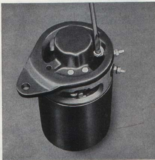
Bild 23. Demontering av förbindningsskena
