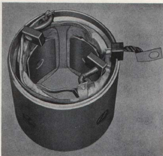
Bild 62. Stator med fastlödda elborstar
