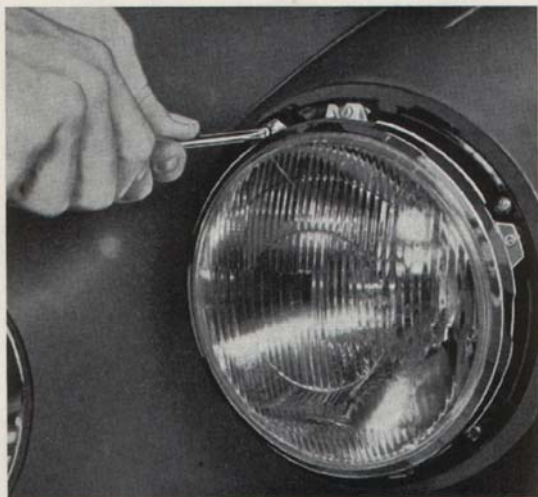
Bild 81. Demontering av strålkastarens innersen. utf.
