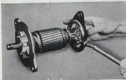
Bild 32. Mätning av borsttryck
