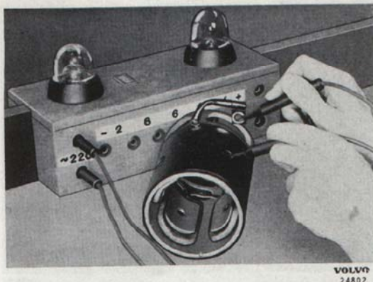
Bild 59. Provning av fältlindning
