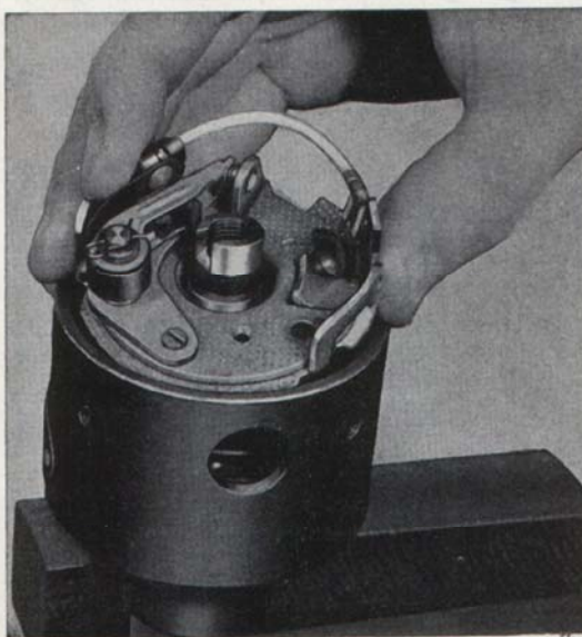
Bild 77. Montering av brytarplatta
