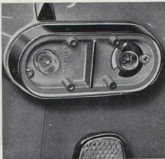
Bild 89. Baklykta, demonterat glas
