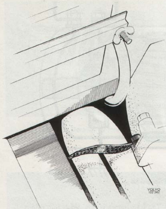
Bild 18. Stomledning, kaross och motor
