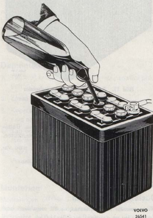
Bild 14. Påfyllning av destillerat vatten
