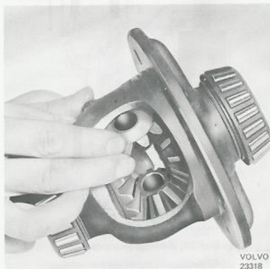
Bild 43. Montering av differentialhjul
