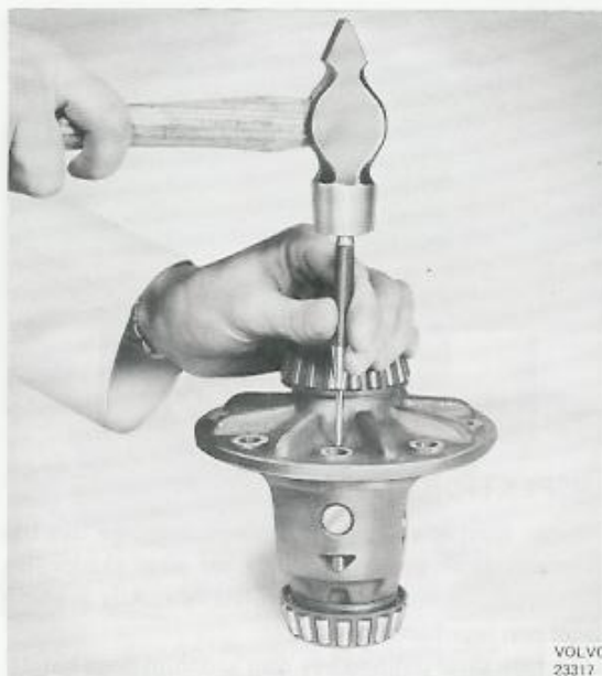
Bild 39. Demontering av låspinne
