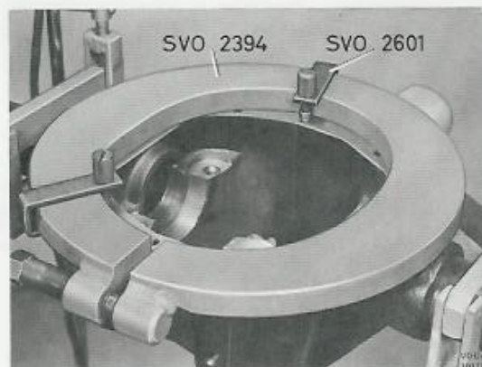
Bild 35. Utspänning av bakväxelhus
