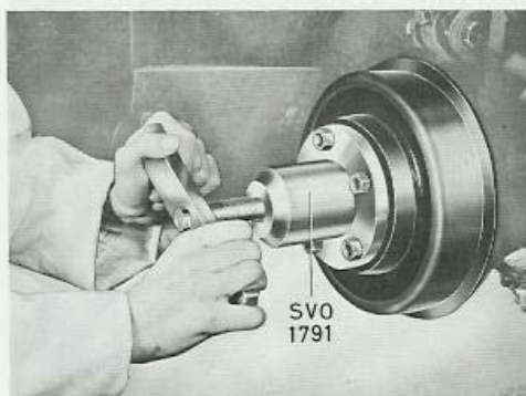
Bild 26. Demontering av nav
