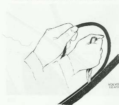
Bild 46. Skärning av vindrutans gummilist
