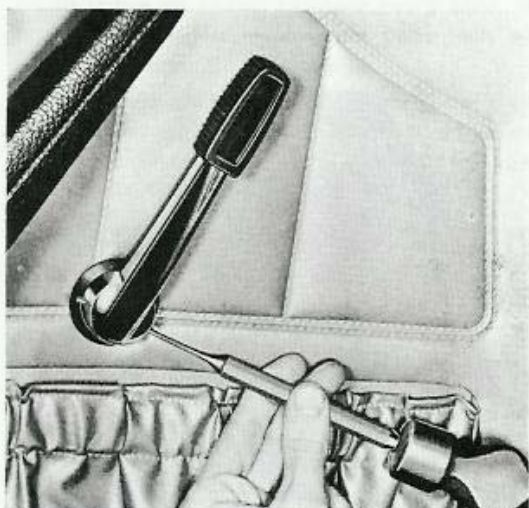
Bild 16. Demontering av inre dörröppnare, sen. utf.
