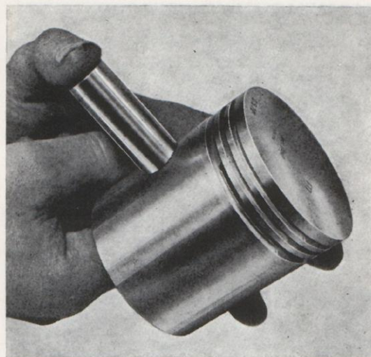
Bild 38. Passning av kolvtapp.
