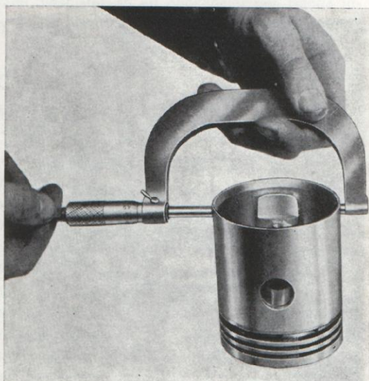
Bild 35. Mätning av kolv.
