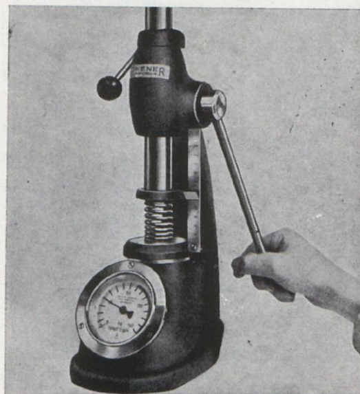
Bild 51. Provning av ventilfjädrar.
