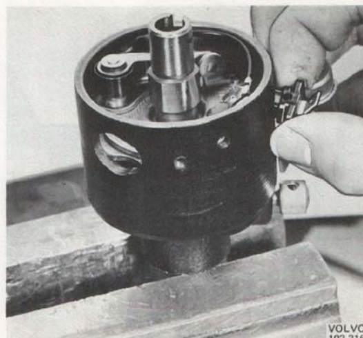
Bild 3-39. Demontering av primäranslutning
