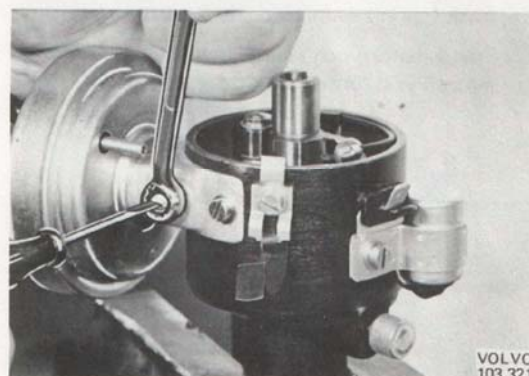
Bild 3-46. Excenter för justering av max tändsänkning
