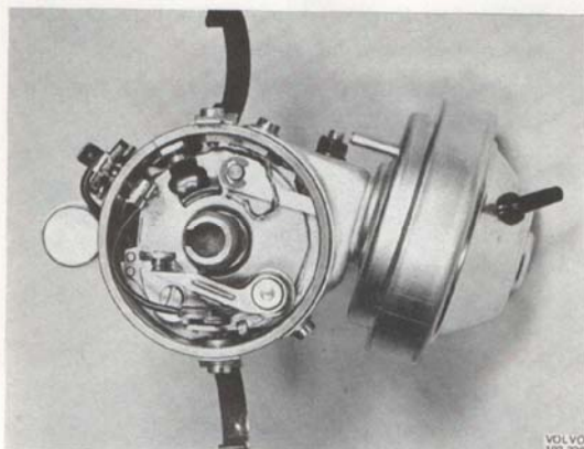
Bild 3-44. Urtag för justering av brytarkontakter
