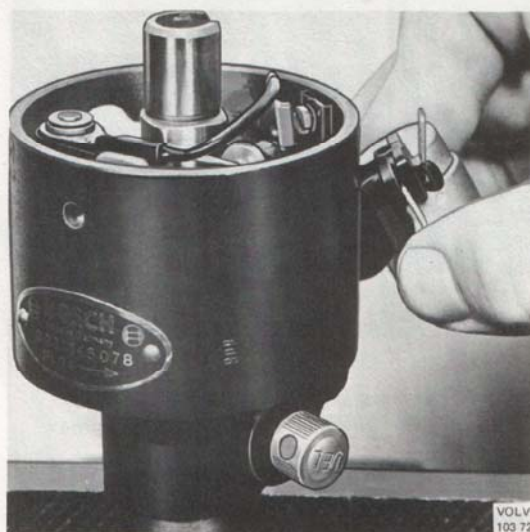
Bild 3-30. Demontering av primäranslutning, B 20 B
