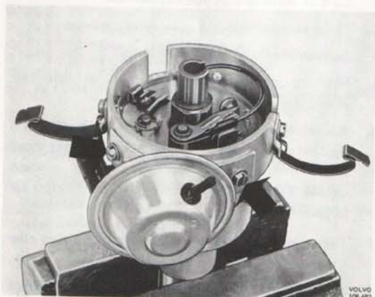
Bild 3-49. Demontering av vakuumregulator
