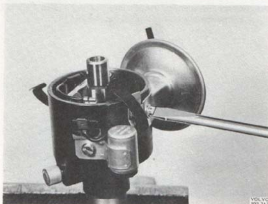
Bild 3-29. Demontering av vakuumregulator, B 20 B
