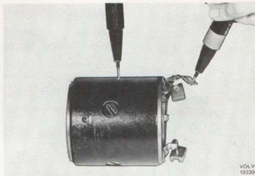
Bild 3-16. Kontroll av stator
