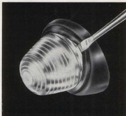
Bild 84. Demontering av glas.
