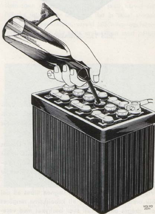
Bild 12. Påfyllning av destillerat vatten.
