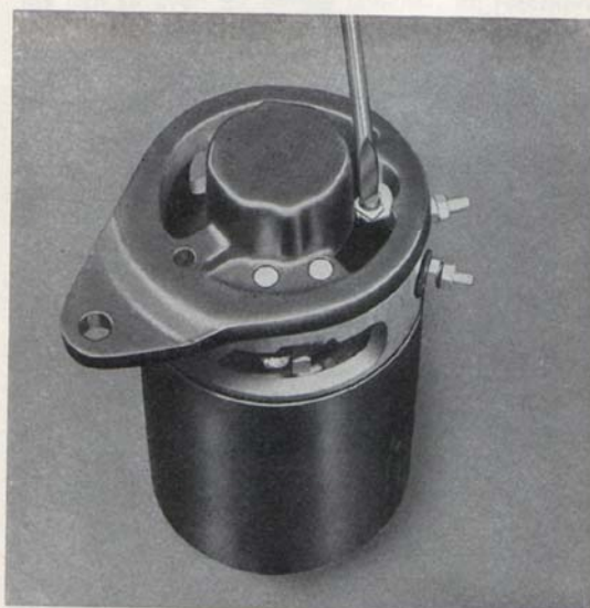
Bild 19. Demontering av förbindelseskena.
