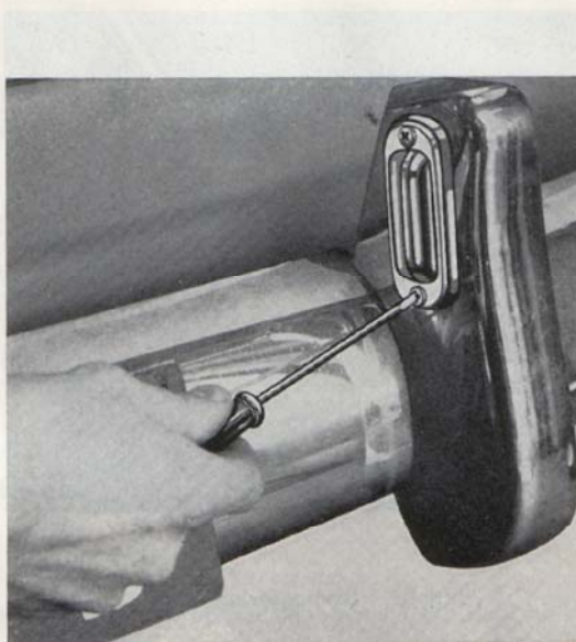
Bild 89. Glas och lamphus lossas.
