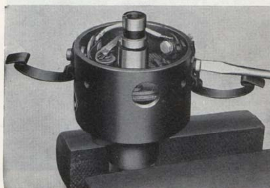
Bild 69. Demontering av brytarplatta.
