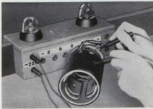
Bild 55. Provning av fältlindning.
