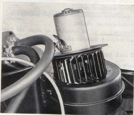
Bild 100. Demontering av bilvärmarens fläktmotor.
