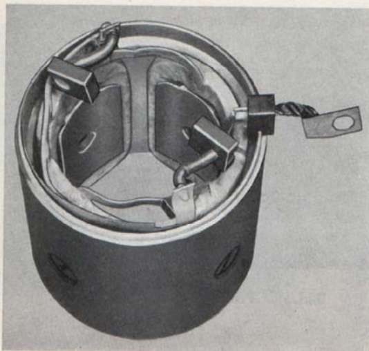
Bild 61. Stator med fastflödda elborstar.
