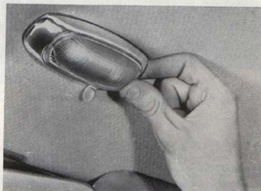
Bild 93. Demontering av innerbelysning.
