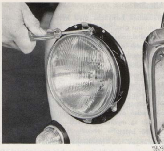
Bild 77. Demontering av hållring.
