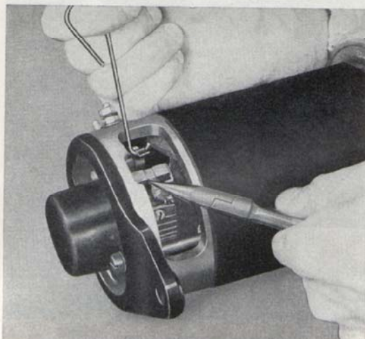
Bild 18. Demontering av elborste.
