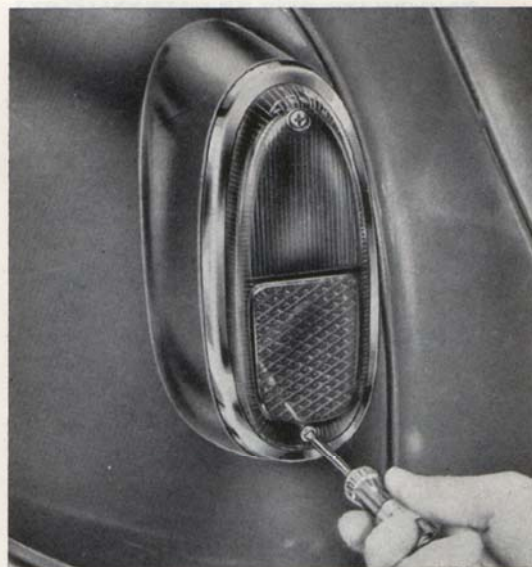
Bild 85. Demontering av glas.
