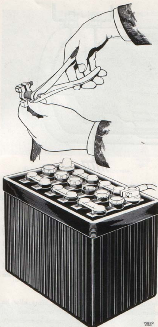
Bild 15. Rengöring av batterikabelsko.
