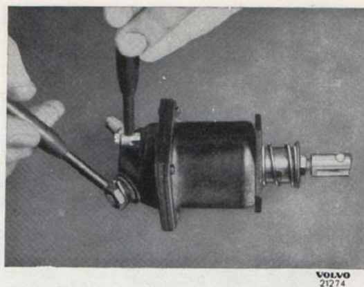
Bild 59. Provning av manövermagnet.
