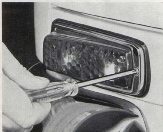
Bild 87. Demontering av glas
