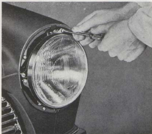
Bild 77. Demontering av hållring.
