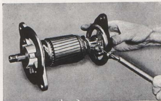
Bild 28. Mätning av borsttryck.
