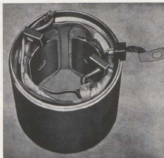
Bild 61. Stator med fastlödda elborstar.
