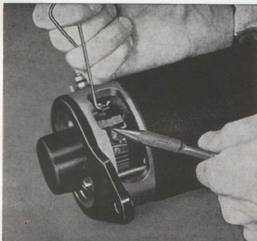
Bild 18. Demontering av elborste.
