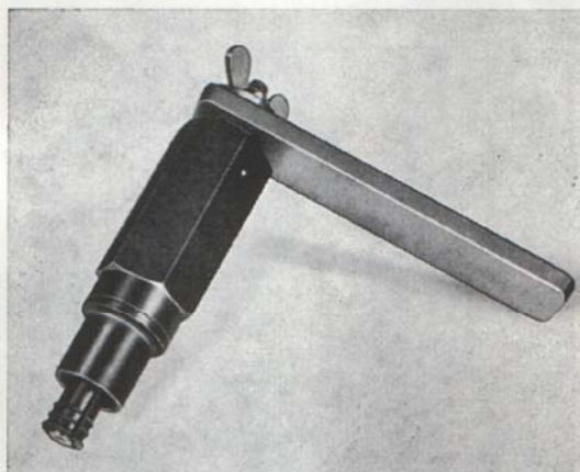
Bild 64. Verktøy för demontering av bussning.
