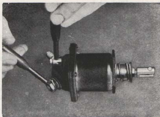
Bild 59. Provning av manövermagnet.
