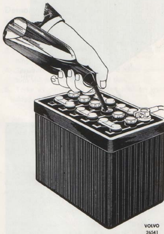
Bild 12. Påfyllning av destillerat vatten.
