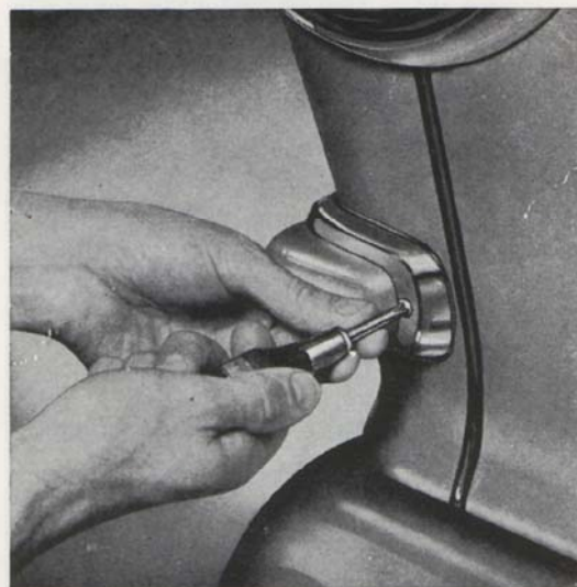
Bild 89. Sargen för parkeringslyktan lossas.
