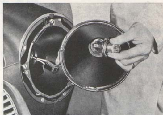
Bild 84. Montering av glödlampa, asymmetrisk.
