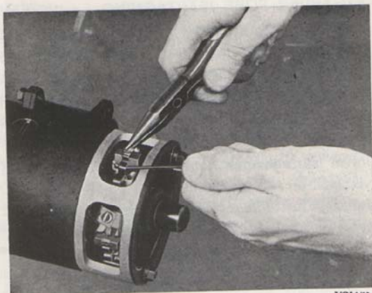
Bild 38. Demontering av elborstar.
