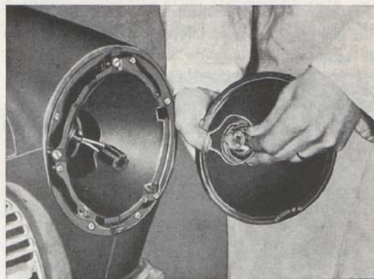
Bild 83. Demontering av hållfjäder för glödlampa.
