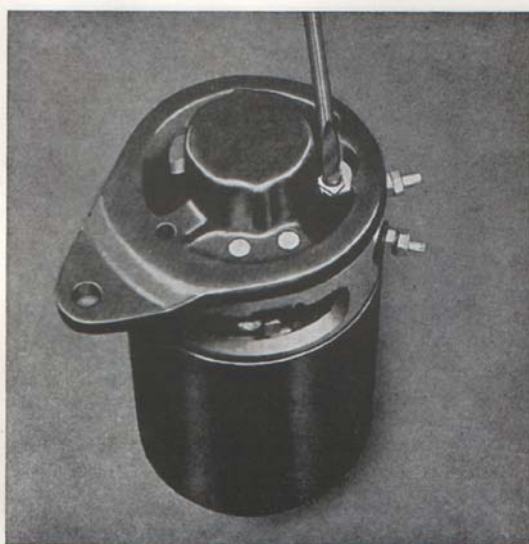
Bild 19. Demontering av förbindelseskena.
