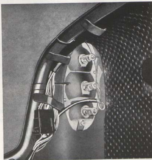
Bild 93. Baklykta, sedd från bagagerummets insida samt kopplingskontakt.
