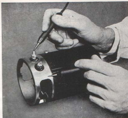
Bild 26. Provning av stator.
