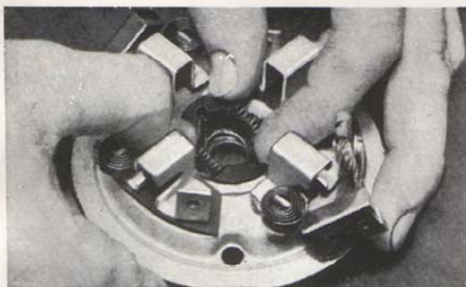
Bild 58. Montering av rotorbroms.
