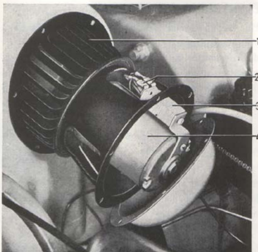
Bild 113. Demontering av bilvärmarens fläktmotor.
