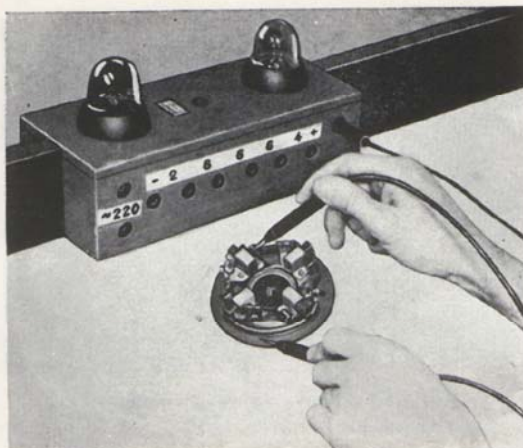
Bild 56. Provning av elborsthållare.
