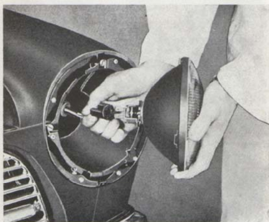
Bild 78. Demontering av kopplingskontakt, symmetrisk strålkastarinsats.
