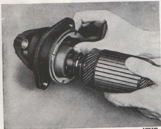
Bild 39. Demontering av drev och rotor.
