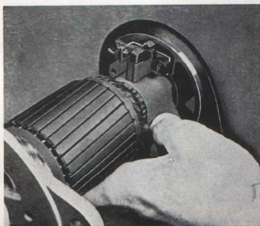
Bild 27. Inslipning av elborstar.
