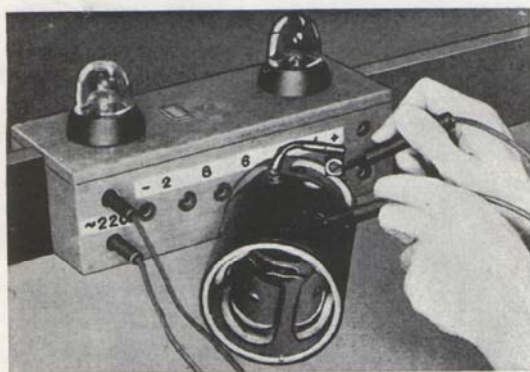
Bild 55. Provning av fältlindning.
