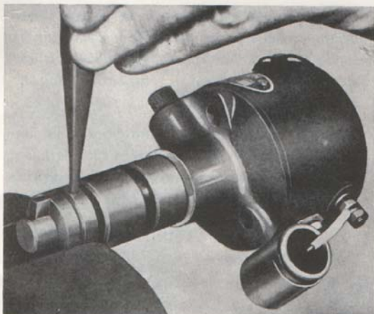
Bild 70. Demontering av medbringare.
