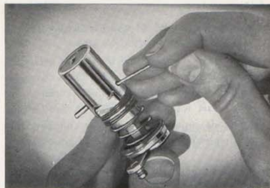
Bild 24. Låsstiftet tryckes ut
