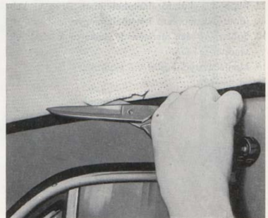
Bild 72. Takklädsel klippes ned
