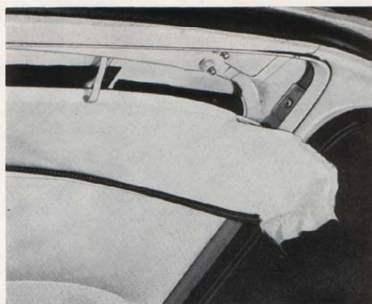
Bild 42. Takklädsel lossas för övre bakluckans gångjärnsmuttrar
