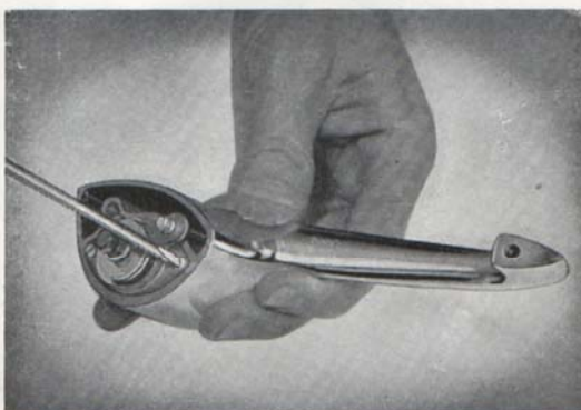
Bild 23. Isärtagning av låshandtag
