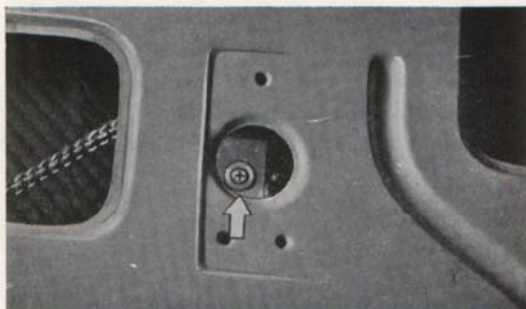
Bild 32. Fästskruv för hissrutans styrskena
