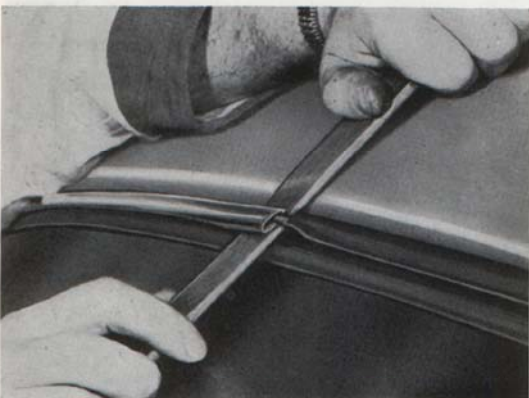
Bild 54. Prydnadslist lossas ur gummilist
