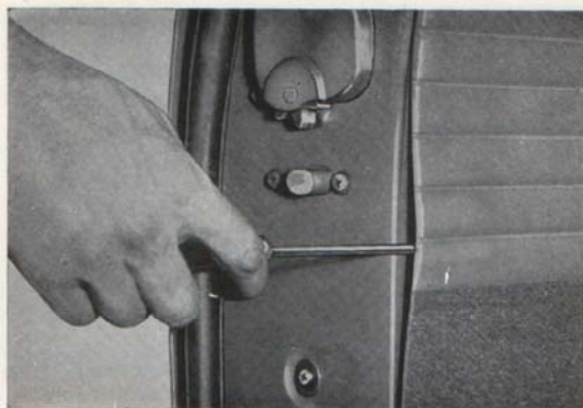
Bild 20. Demontering av dörrklädsel
