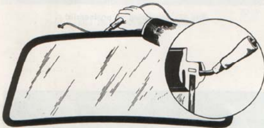
Bild 60. Insättning av snöre i gummilist
