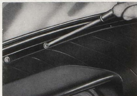
Bild 77. Demontering av prydnadslist för vindruta
