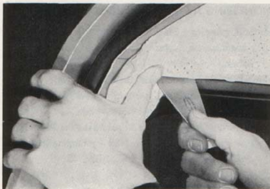
Bild 44. Takklädseln monteras i hörnen
