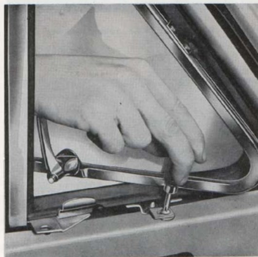
Bild 30. Fästskruv för ventilationsruta
