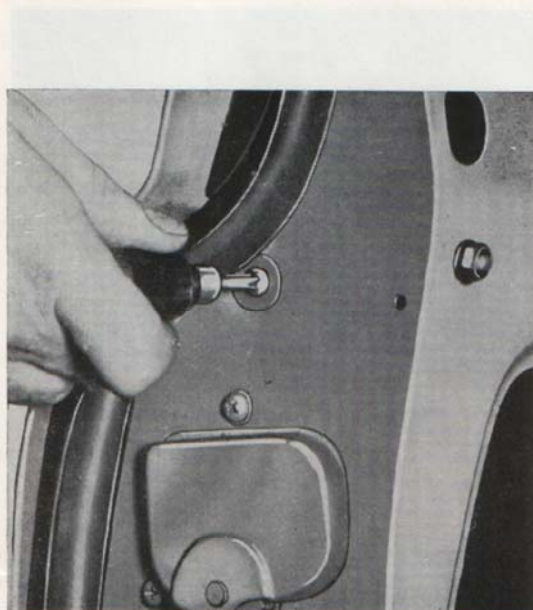
Bild 21. Övre skruv för styrskena lossas
