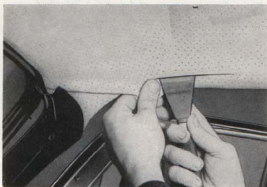
Bild 76. Takklädsel sträckes och fästes på hajlist
