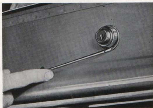
Bild 40. Låsring för låstryckknappen lossas
