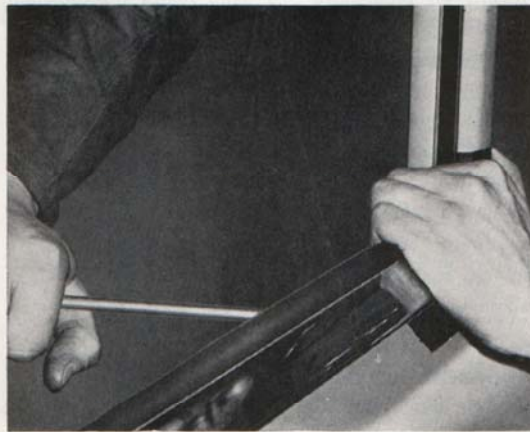
Bild 48. Demontering av bältlist
