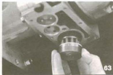
Bild 63 Nä, trycket var för lågt och ändå hade jag tillräckligt med olja. Låt mig se. Hur är det med filtret? Kanske det är igensatt. Här har jag tatt bort oljesumpen och tar ned filtret och gör rent det. Nä, det såg inte bra ut.
