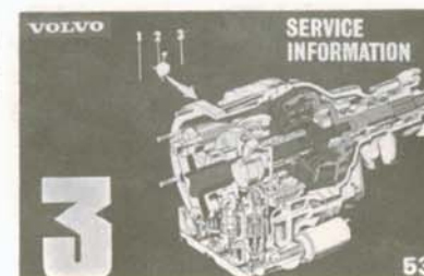
Bild 53 I 3:e delen om överväxeln går vi igenom en enkel felsökning och kontroll av överväxelns kontrollsystem som Du kan göra med överväxeln på plats i vagnen.
