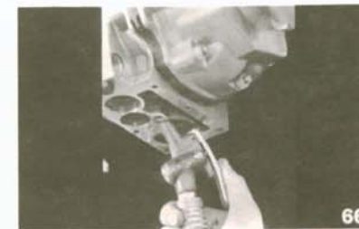
Bild 66 Så återstår bara att ta bort manöverventil och solenoid och blåsa ren kanalerna.
