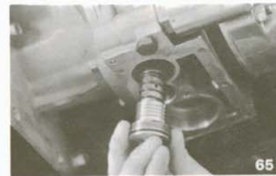
Bild 65 Och när jag ändå är i farten, kan jag väl kontrollera reducerventilens detaljer. Dom sitter innanför pluggen närmast solenoiden. Det kan ju vara smuts här, så att reducerventilen kärvar.
