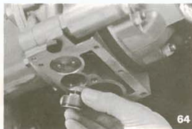
Bild 64 Så tar jag ner den här pluggen och kollar pumpens backventil. Den sitter ju innanför den mitre pluggen. Bäst att jag ser till att jag inte tappar sätet som sitter ovanför kulan.
